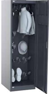
Armoire de séchage en tôle d'acier zinguée à chaud, thermolaquée, disposant chacune de 8 bras de séchage en aluminium avec buses de séchage spéciales en plastique pour chaussures (4 paires) et pour gants (4 paires), 4 cintres amovibles à circulation d'air en acier inoxydable (Air Hanger) pour suspendre vestes et pantalons, ainsi que 4 supports pour casques à circulation d'air.
